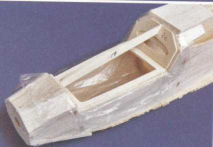
Aufbau der Haube auf dem Rumpf (einmotorige Version)
