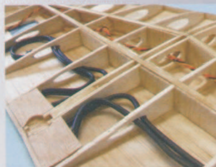
Tragfläche mit Verkastung und eingezogenen Kabeln für den Druckantrieb
