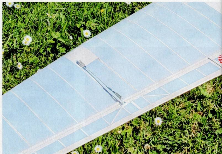
Die Ruderanlenkungen liegen auf der Flächenoberseite.
