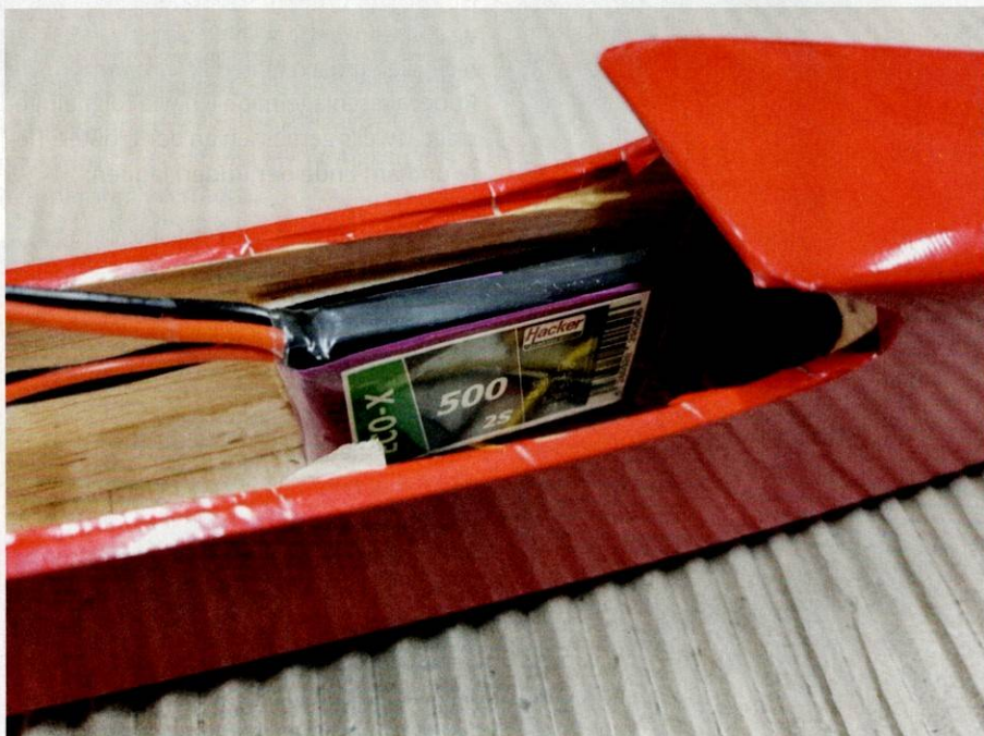
▲ Beim Elektrorumpf kann der Deckel nach der Motormontage überbügelt werden – der Akku liegt direkt unter dem Flächenausschnitt.
