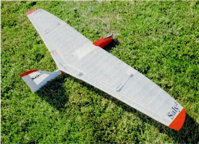
Der Saly² kann mit zwei Rümpfen gebaut werden: Hier ist der Elektro-Rumpf montiert.
