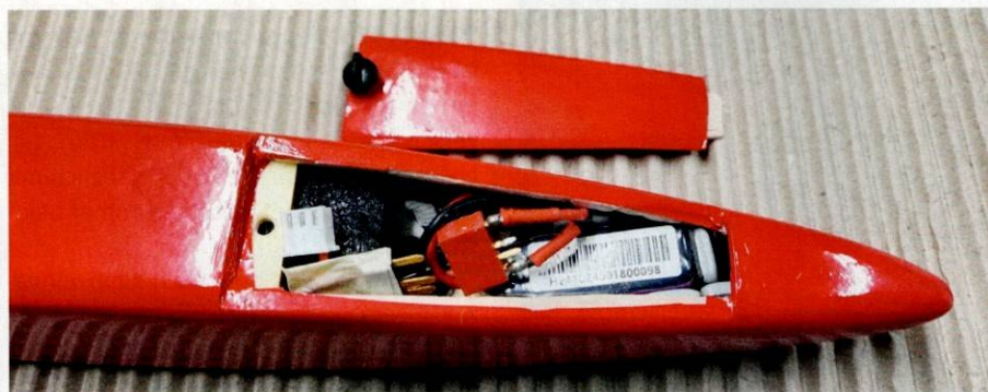
In der Segler-Version muss alles soweit wie möglich nach vorn – ein Rumpfdackel ist nötig.
