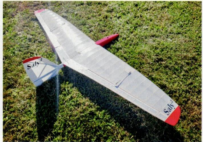
Als Segler hat der Saly² eine längere Nase und ein deutlich größeres Seitenleitwerk.
