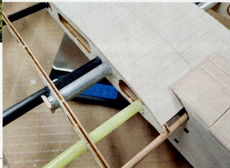
Die Beplankung des Flächen-Mittelfeldes schafft zusätzliche Stabilität und Griff-Festigkeit beim Auf- und Abrüsten.
