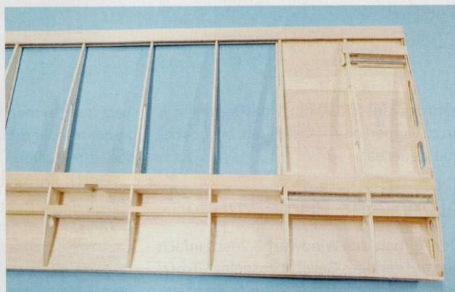
Die Öffnungen der Rohre mit Balsastücken verschließen, um ein Hineinrutschen der Steckung in die Fläche zu vermeiden.
