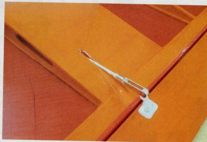
Auf der Flächenoberseite schneidet man dann eine kleine Öffnung für die Schubstange aus.
