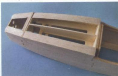
Das eingebaute Leitwerk: die Übergänge sind bereits mit Spachtelmasse angeglichen
