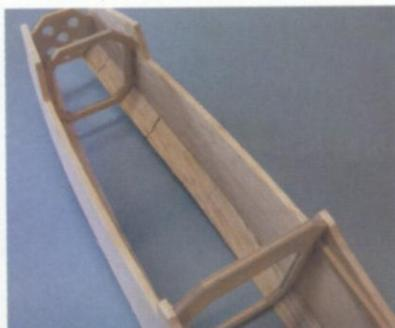
Die Haube wird direkt in der Rumpfoffnung aufgebaut; Folie zwischenlegen!
