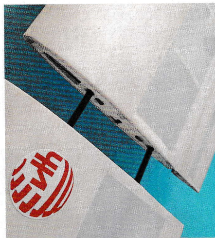
Die Ohren können steckbar gebaut werden – für kompakte Transportmaße.
