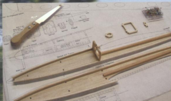
Aufbau der Rumpfsseiten, hier für die Segler-Version
