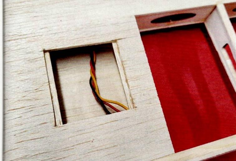
Auf der Flächenunterseite werden Servo-schächte ausgeschnitten und innen zwei Balsastreifen als Auflage eingeklebt.
