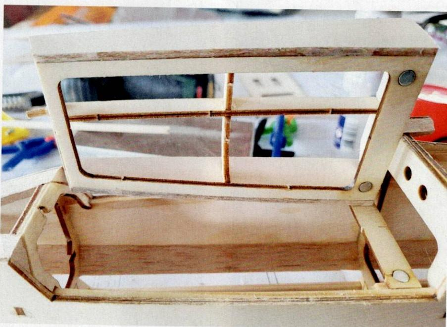
Gehalten wird die Kabinenhaube vorn mit einem Stift, hinten mit vier 6×3-mm-Magneten.
