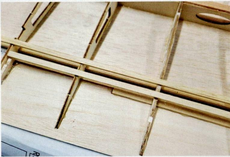
Wölbklappe und Querruder werden erst später ausgetrennt – zuvor werden die zusätzlichen Holme und Abschlussrippen gesetzt.
