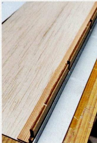
▲ Der erste Schritt beim Flächenbau: Rippenkamm und Hauptholm werden auf der unteren Beplankung ausgerichtet und verklebt.
