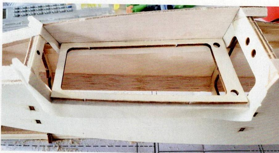
Der Aufbau des Kabinenrahmens erfolgt auf dem Rumpf.
