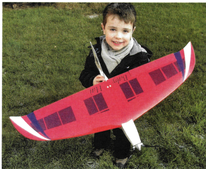
Baby-Hai von 2009: ein kompakter Brett-Nurflügel (970 mm Spann- weite) mit er- staunlichen Flug- leistungen für 2s bis 3s-LiPos.
