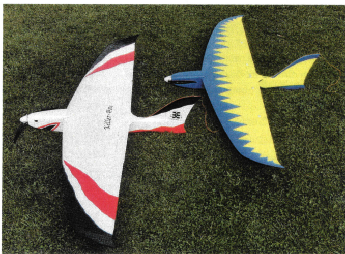
Killer-Hai von 2009: gutmütiger Nurflügel-Hotliner mit 1.600 mm Spannweite und für 3s- bis 4s- LiPos.
