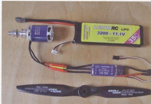
Kraftvoller Antrieb für die Druine Akrobat: der Boost 30 mit 50-A-Regler, 3S-LiPo und 11x6" CAMCarbon von aero-naut.
